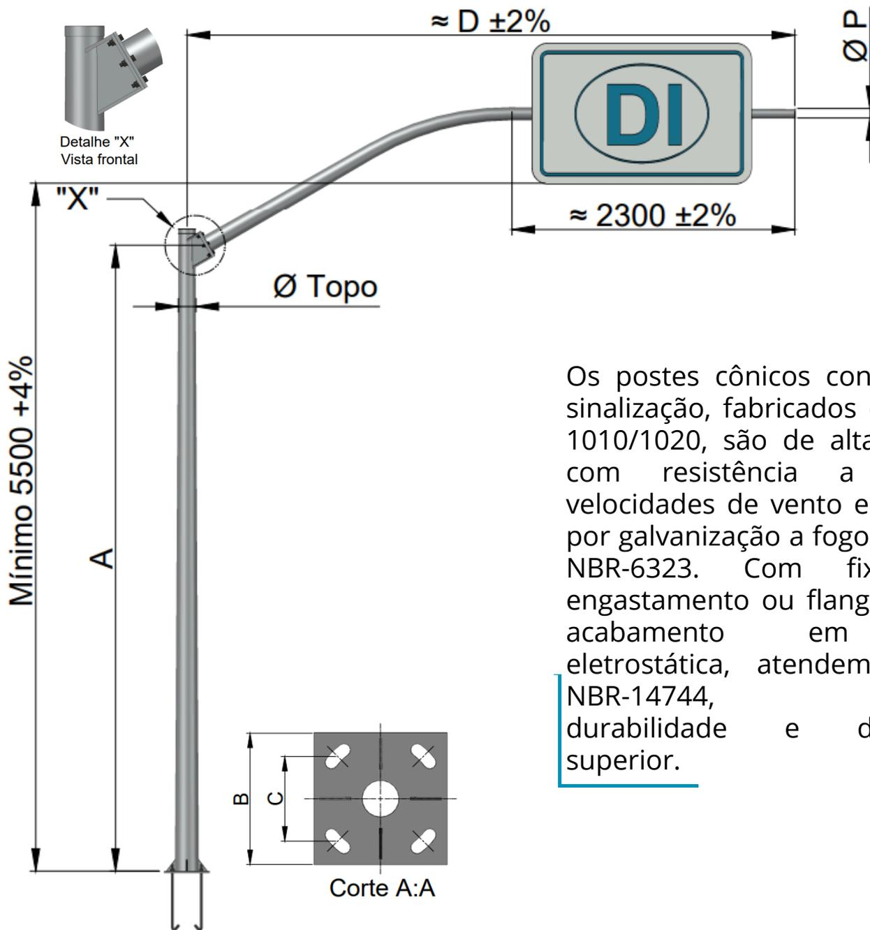
Os postes cônicos contínuos para sinalização, fabricados em aço SAE 1010/1020, são de alta qualidade, com resistência a diferentes velocidades de vento e tratamento por galvanização a fogo conforme a NBR-6323. Com fixação por engastamento ou flange, opção de acabamento em pintura eletrostática, atendem à norma NBR-14744, garantindo durabilidade e desempenho superior.
