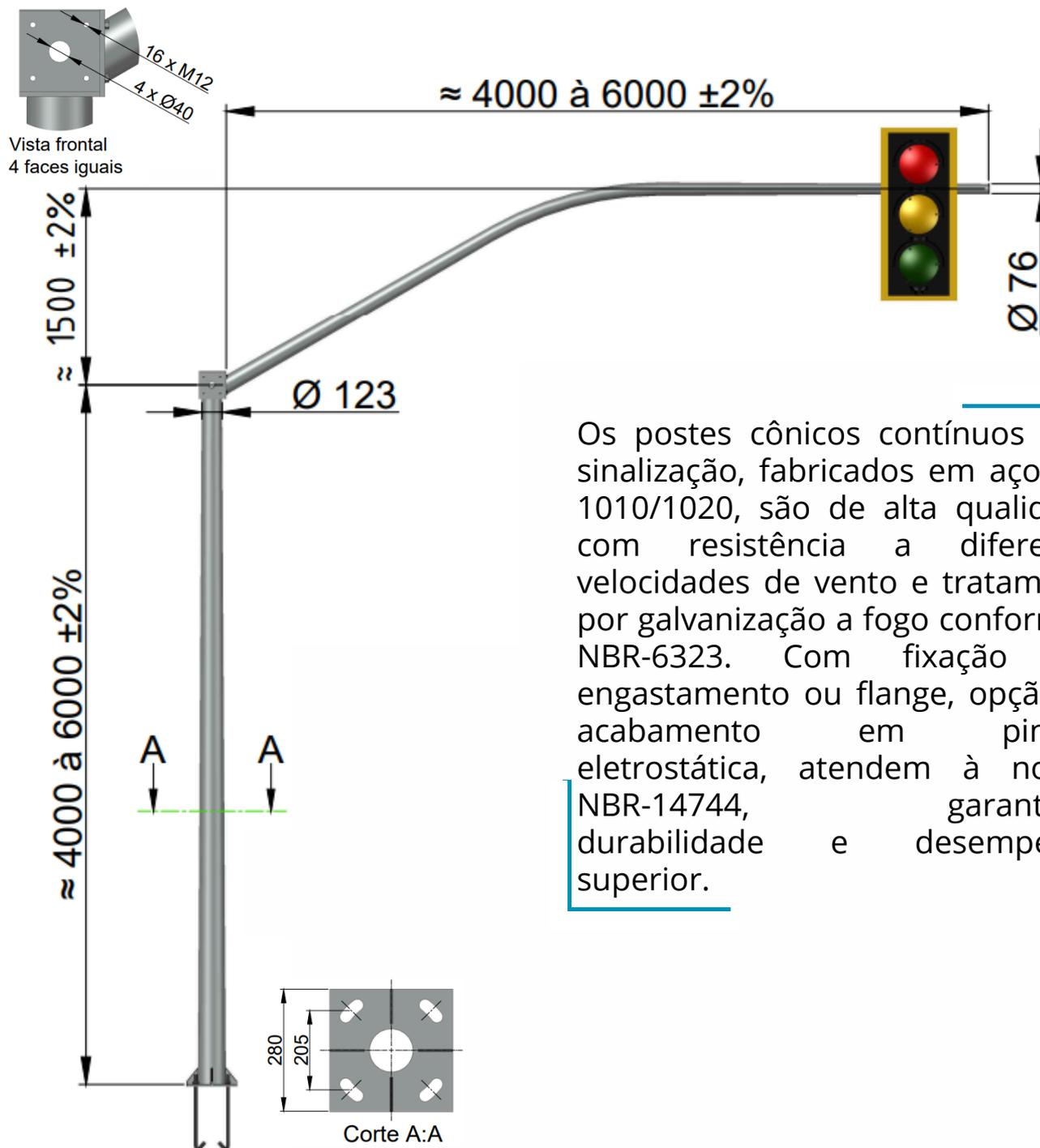
Os postes cônicos contínuos para sinalização, fabricados em aço SAE 1010/1020, são de alta qualidade, com resistência a diferentes velocidades de vento e tratamento por galvanização a fogo conforme a NBR-6323. Com fixação por engastamento ou flange, opção de acabamento em pintura eletrostática, atendem à norma NBR-14744, garantindo durabilidade e desempenho superior.
