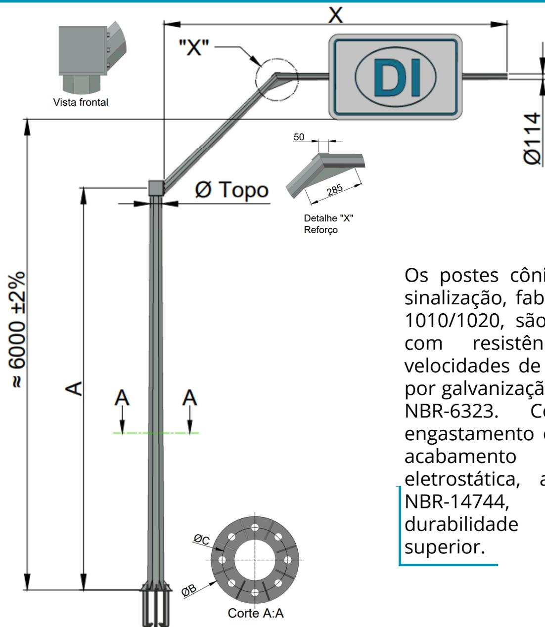
Os postes cônicos contínuos para sinalização, fabricados em aço SAE 1010/1020, são de alta qualidade, com resistência a diferentes velocidades de vento e tratamento por galvanização a fogo conforme a NBR-6323. Com fixação por engastamento ou flange, opção de acabamento em pintura eletrostática, atendem à norma NBR-14744, garantindo durabilidade e desempenho superior.
