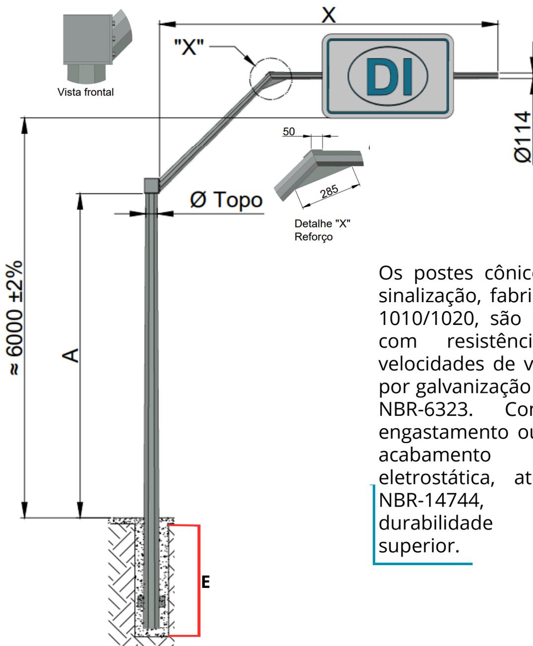
Os postes cônicos contínuos para sinalização, fabricados em aço SAE 1010/1020, são de alta qualidade, com resistência a diferentes velocidades de vento e tratamento por galvanização a fogo conforme a NBR-6323. Com fixação por engastamento ou flange, opção de acabamento em pintura eletrostática, atendem à norma NBR-14744, garantindo durabilidade e desempenho superior.
